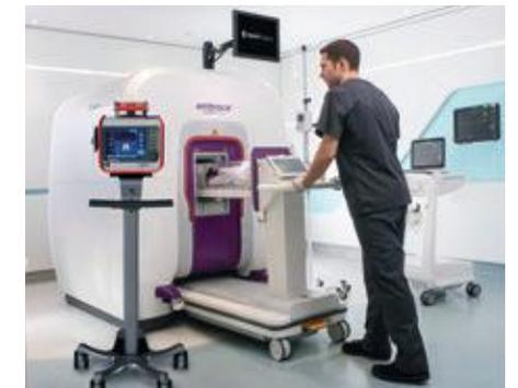
Ausgestattet mit modernster Technologie liefert Embrace® Bilder in herausragender Qualität und ermöglicht so eine sichere Untersuchung und Diagnostik des neonatalen Gehirns. Das System verfügt über einen selbstabschirmenden 1-Tesla-Permanentmagneten sowie eine Gradientenstärke von 150 mT/m - und das praktisch ohne externes Magnetfeld.
